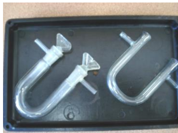
Fig.II.10. Tuburi de absorbție
