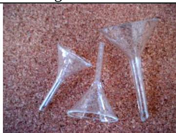
Fig.II.16 Pâlnia de filtrare
