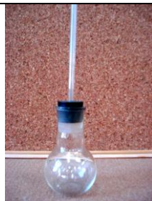
Fig.II.20 Refrigerent cu aer
